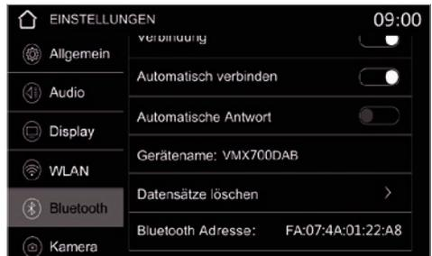
Unter **Automatisch verbinden** und **Automatische Antwort** können Sie festlegen, ob Ihr Smartphone nach einem Neustart automatisch mit dem Gerät verbunden werden soll und ob Anrufe automatisch angenommen werden sollen. Unter **Datensätze löschen**, können Sie bereits registrierte Geräte wieder löschen.
