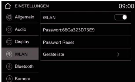
Unter **Wi-Fi** können Sie die WLAN-Funktion an- oder ausschalten. Diese Funktion wird für Apple CarPlay sowie Android Auto benötigt.
