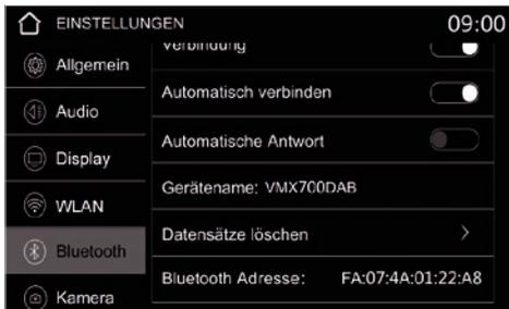
Unter **Bluetooth** können Sie Ihr Smartphone für die Freisprechfunktion mit dem Gerät verbinden. Diese Funktion wird auch für Apple CarPlay sowie Android Auto benötigt.
