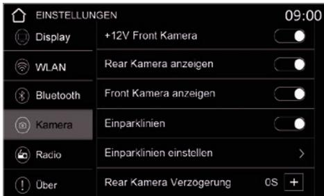
Mit dem Schieberegler **Einparklinien** können Sie Führungslinien der Rückfahrkamera einschalten. Mit **Einparklinien einstellen**, können Sie die Führungslinien anpassen.
