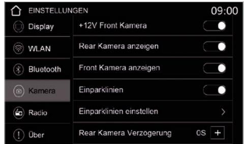
Hier können Sie die Rückfahr- oder Frontkamera einschalten, die jeweilige Stromversorgung über das Gerät anschalten sowie die jeweilige Ansicht im Kamera-Menü aktivieren.
