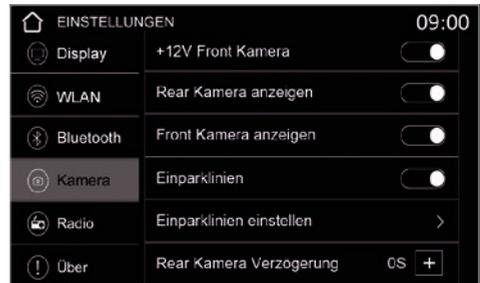
Unter **Rear Kamera Verzögerung** können Sie die Verzögerung in Sekunden mit **+** einstellen, mit der die Rückfahrkamera beim Einlegen des Rückwärtsgangs auf dem Monitor angezeigt werden soll.
