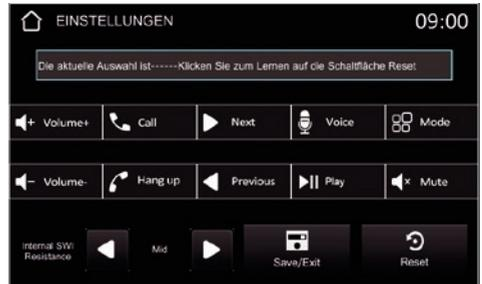
Sofern Ihre Lenkradfernsteuerung richtig am Gerät angeschlossen wurde, können Sie hier die einzelnen Funktionen dem Gerät anlernen. Sobald Sie alle Funktionen zugeordnet haben, verlassen Sie das Menü mit **Save/Exit**.
