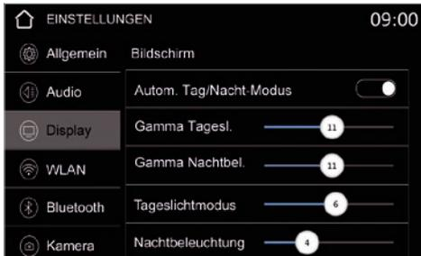
Mit **Autom. Tag/Nacht-Modus** können Sie die Steuerung für den Tag- und Nachtlichtmodus über das angeschlossene Abblendlichtsignal aktivieren.
