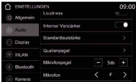
Unter **Interner Verstärker** können Sie integrierten Audioverstärker des Geräts an- oder ausschalten. Schalten Sie den Verstärker ab, falls Sie mit den Vorverstärkerausgängen des Geräts einen externen Audioverstärker ansteuern.
