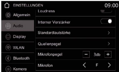
Unter **Mikrofonpegel** können Sie die Lautstärke des Mikrofons der Freisprechfunktion mit **- / +** einstellen.
