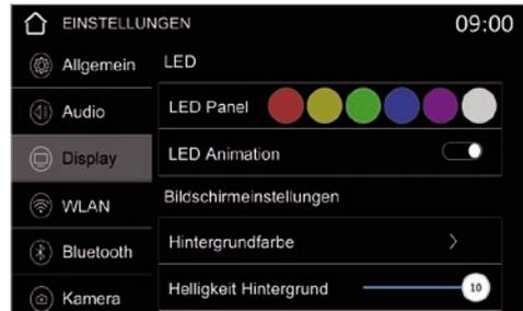
Mit **LED Animation** aktivieren Sie die sich wechselnde, farbige LED-Beleuchtung der Funktionstasten auf dem Bedienpanel.
