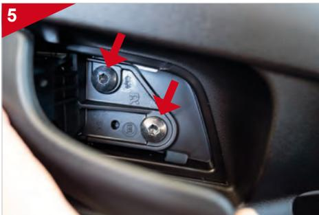
Entfernen Sie die beiden Schrauben hinter dem Türgriff.
