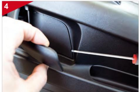
Entfernen Sie die Abdeckung hinter dem Türgriff mittels eines geeigneten Schraubendrehers.
