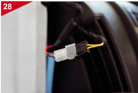
Verbinden Sie den ESX-Hochtöner mit dem Anschlussstecker des Fahrzeugs.
