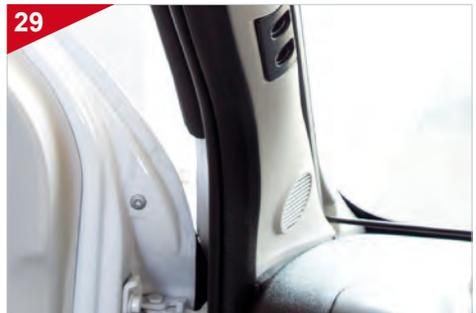
Klappen Sie die Abdeckung wieder an die ursprüngliche Stelle zurück und setzen die Gummidichtung wieder in die Türöffnung ein.
