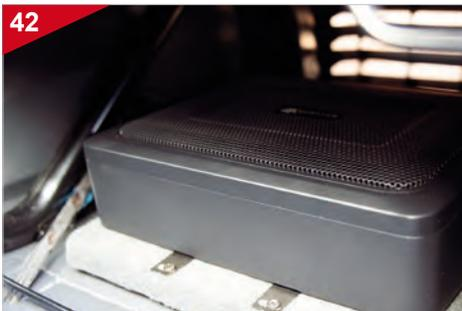
**OPTIONAL:** Ein aktives Subwoofer-System wie das ESX Q168A kann beispielsweise unter dem Fahrersitz montiert werden.
