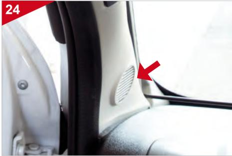
Beginnen Sie mit der Installation der Hochtöner auf der Fahrerseite. Wiederholen Sie anschließend alle Einbauschritte auf der Beifahrerseite.
