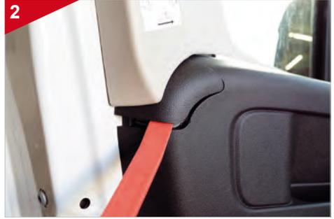
Zunächst muss die Türverkleidung entfernt werden. Lösen Sie dazu die Abdeckung links unten am Fenster mit einem Montagekeil.
