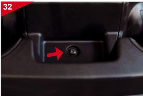
32 Entfernen Sie die Schraube unter der Gummieinlage.
