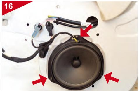
Ziehen Sie oben am Lautsprecher den Anschlussstecker ab und entfernen dann die drei Schrauben am Lautsprecher.
