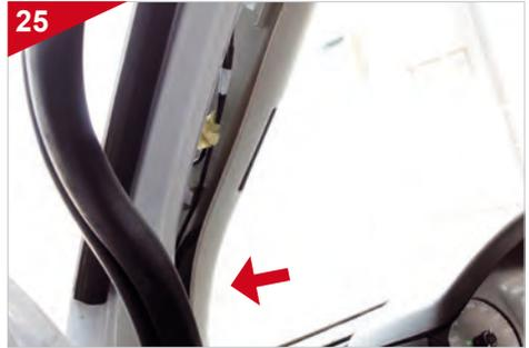
Hebeln Sie die Gummidichtung des Türöffnung mit einem Montagekeil heraus und ziehen diese vorsichtig an der entsprechenden Stelle heraus.
