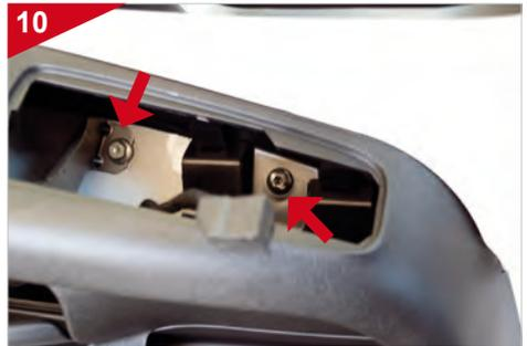
Entfernen Sie die beiden Schrauben unter der Bedieneinheit.
