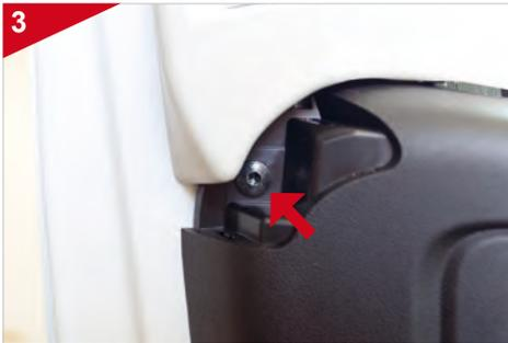
Entfernen Sie die Schraube links unten am Fenster.
