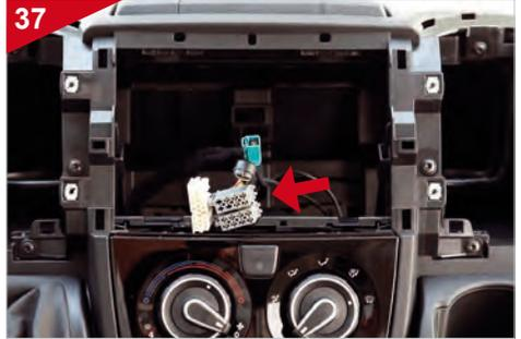
Stecken Sie die beiden ISO-Stecker entsprechend in die ISO-Buchsen (B und D) der beiliegenden Kabelbäume des Verstärkers ein.
