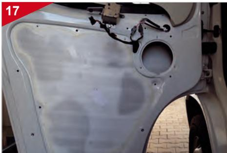
**OPTIONAL:** Eine wesentliche Klangverbesserung wird durch das Dämmen der Tür mit Aluminium-Butyl erreicht.
