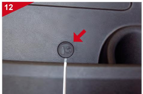
Entfernen Sie die kleine runde Abdeckung links neben dem Getränkehalter und entfernen dann die Schraube darunter.
