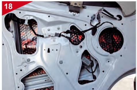
**OPTIONAL:** Entfernen Sie dazu den weißen Schaumstoff und verkleben die Aluminium-Butyl-Platten innerhalb der Tür.
