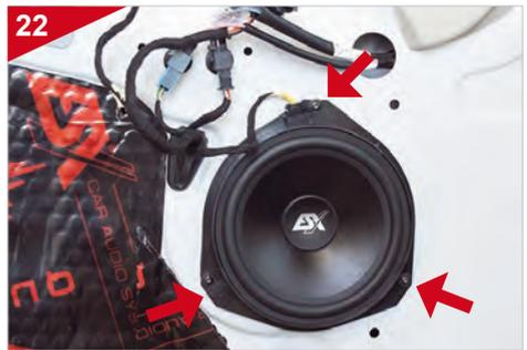
Setzen Sie den ESX Lautsprecher ein, befestigen ihn mit den drei Original-Schrauben und stecken oben den Anschlussstecker ein.
