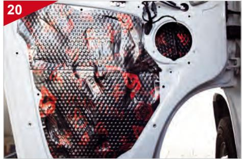
**OPTIONAL:** Überkleben Sie anschließend den kompletten Bereich, der zuvor mit dem weißen Schaumstoff abgedeckt war, welchen Sie auch als Schnittschablone verwenden können.
