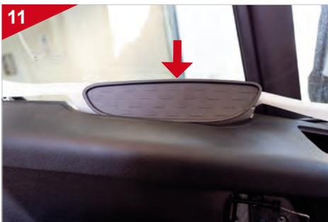
Hebeln Sie die Gummieinlage oberhalb des Türgriffs heraus, legen diese beiseite und entfernen die Schraube darunter.
