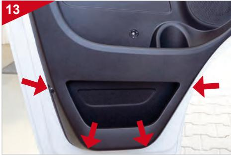
Entfernen Sie die restlichen vier Schrauben an der Türverkleidung wie oben markiert.
