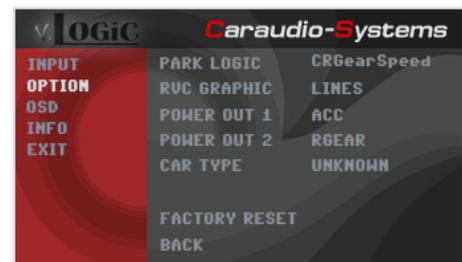
3 Ausnahme: Sollte das System nach der Installation und dem hier beschriebenen OSD-Setup (siehe nächstes Kapitel) nicht automatisch auf die Rückfahrkamera umschalten, so muss das weiße Kabel des Kabelsatzes V5C-AU03 an das Rückfahrlichtsignal (+12V des Rückfahrlichts) angeschlossen werden.
