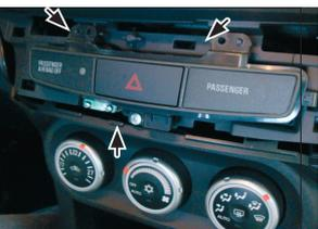
3. Entfernen Sie die Schaltereinheit
