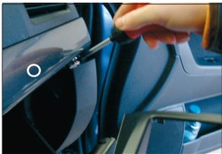
1. Entfernen Sie die Schrauben rechts und links von der Blende
