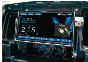
5. Befestigen Sie die Metallhalterungen am Nachrüst Radio und schließen alle Kabel an
