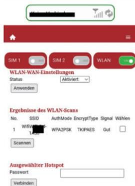
Setzen Sie den Status für die WWAN-Einstellungen auf „Aktiviert“, übernehmen Sie die Änderungen und warten Sie den Neustart des Systems ab. Suchen Sie anschließend über die Scan-Schaltfläche nach Wi-Fi/WLAN-Netzwerken in Ihrer Nähe. Wählen Sie das Netzwerk aus, mit dem Sie sich verbinden möchten, und stellen Sie die Verbindung durch Eingabe des Passworts her. Der Router speichert das zuletzt gewählte Netzwerk mitsamt Passwort, auch wenn er ausgeschaltet wird.
