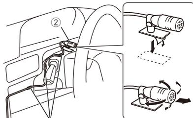
Befestigen Sie das Kabel mit handelsüblichem Klebeband.
